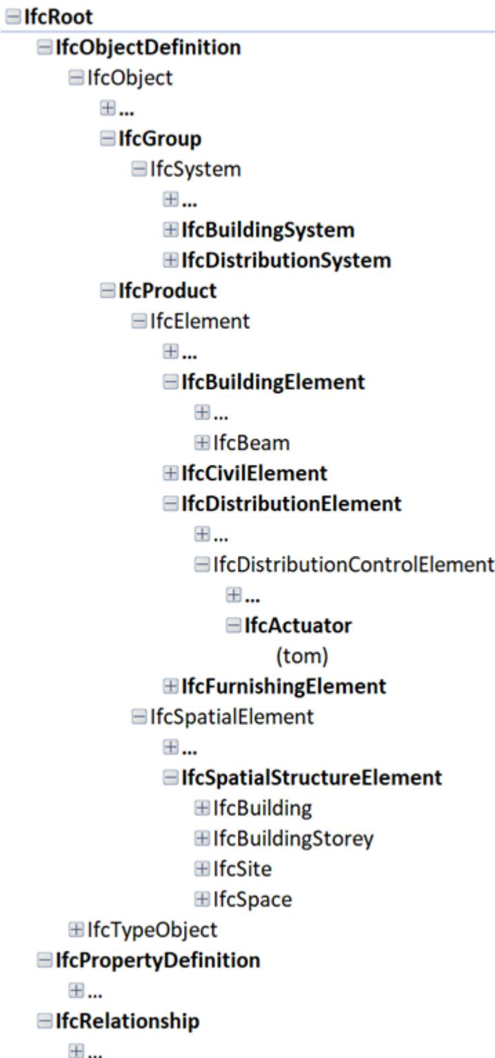
För att kunna utföra mappning av parametrar mellan originalprogramvaror och IFC-entiteter krävs grundläggande kunskap om IFC-formatets struktur och hierarkier. Figuren nedan visar en mycket förenklad beskrivning av en del av IFC-strukturen, de så kallade rooted entities. De p
