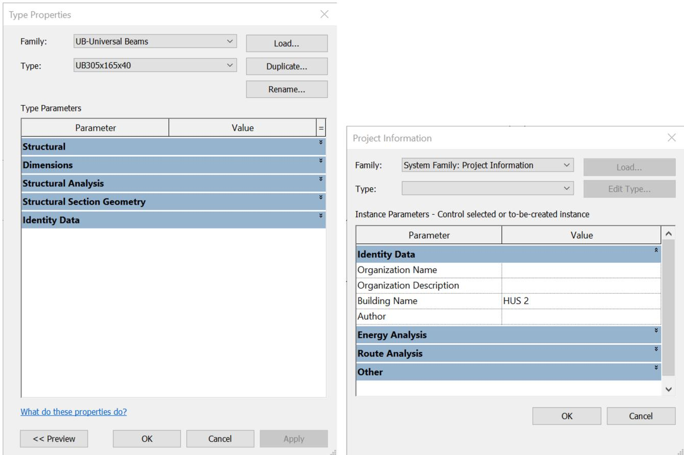
För att lösa detta kan parametern *Benämning* både mappas mot IfcElement (för balken) och IfcBuilding för byggnaden där parametern för IfcElement mappas mot parametern *Type* och parametern för IfcBuilding mappas mot parametern *Building Name* i originalprogramvaran. Se exempel i tabellen nedan.
